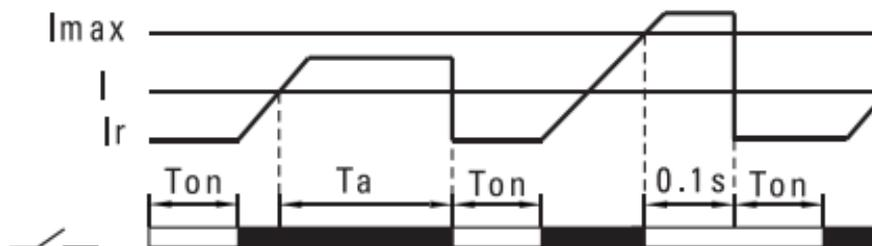
$T_{on}$  – время задержки включения
