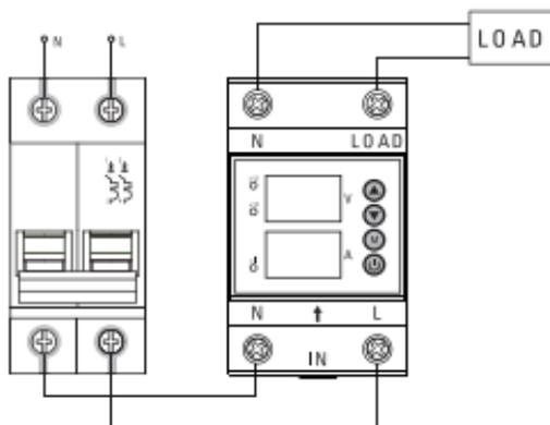
Рис. 8 - Схема подключения
