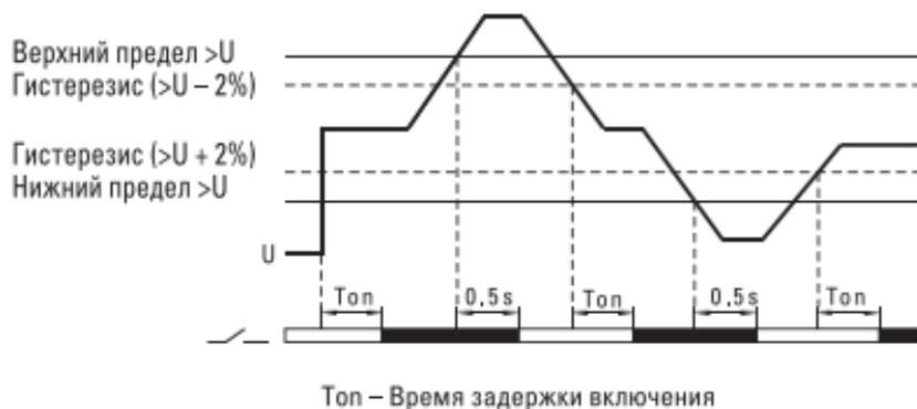
Рис. 1 - Диаграмма напряжения реле
