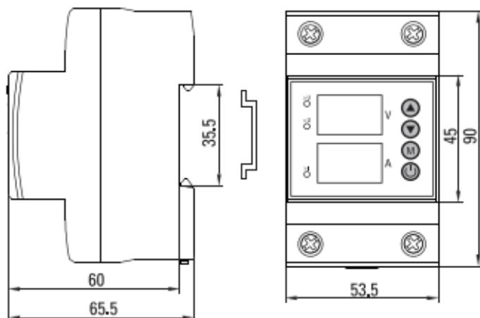
Рис. 9 - Габаритные и установочные размеры
