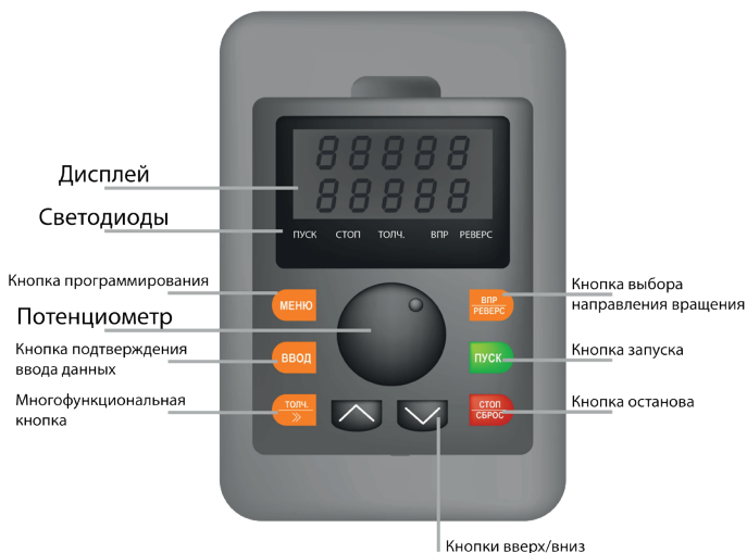
Рис. 5.1.1 Функции кнопок и светодиодов панели управления
