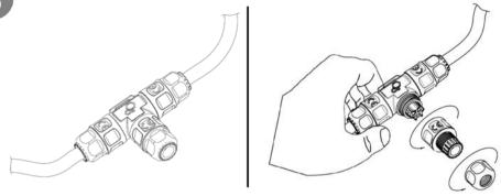
Зачистить провод питания согласно рисунку. Завести питающий провод (макс. сечение жил 2,5 мм²), подключить к клеммной колодке, согласно указанной полярности проводов. Зафиксировать провода винтами.
